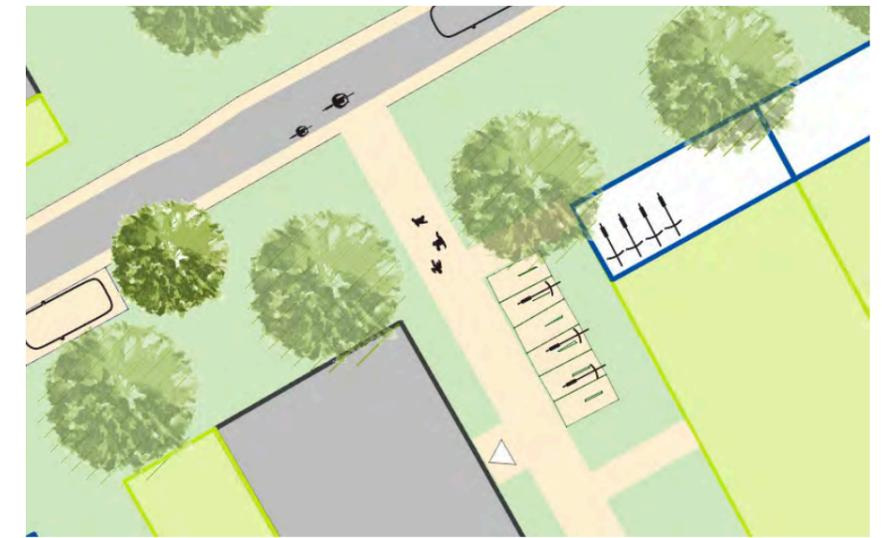
Detail: Freistehende Fahrradbügel direkt vor der Haustür auf einem nicht vollständig versiegeltem Bereich des Zugangsweges. Zusätzlich Zugang zu Werkstatt-Hütten, die als überdachte Abstellanlagen (mit Lade-Möglichkeit für E-Bikes) genutzt werden können.
